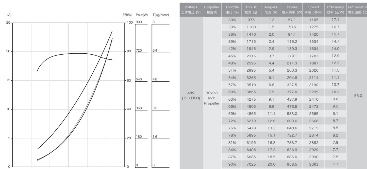
以上数据为好盈实验室于室温 25°C、海平面高度环境下变化油门输入调节测得，电机温度为额定点油门运行10分钟测得，仅供参考。
