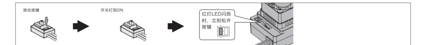
1、打开遥控器，将油门通道的“D/R”、“EPA”、“ATL”等参数调到100%（如遥控器无显示屏，则将对应旋钮调到最大位置），油门通道的中点微调“TRIM”调为0（如遥控器无显示屏，则将对应旋钮调到中间位置）。
