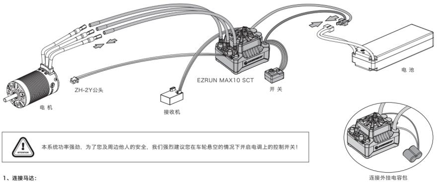
⚠️ 本系统功率强劲，为了您及周边他人的安全，我们强烈建议您在车轮悬空的情况下开启电调上的控制开关！
