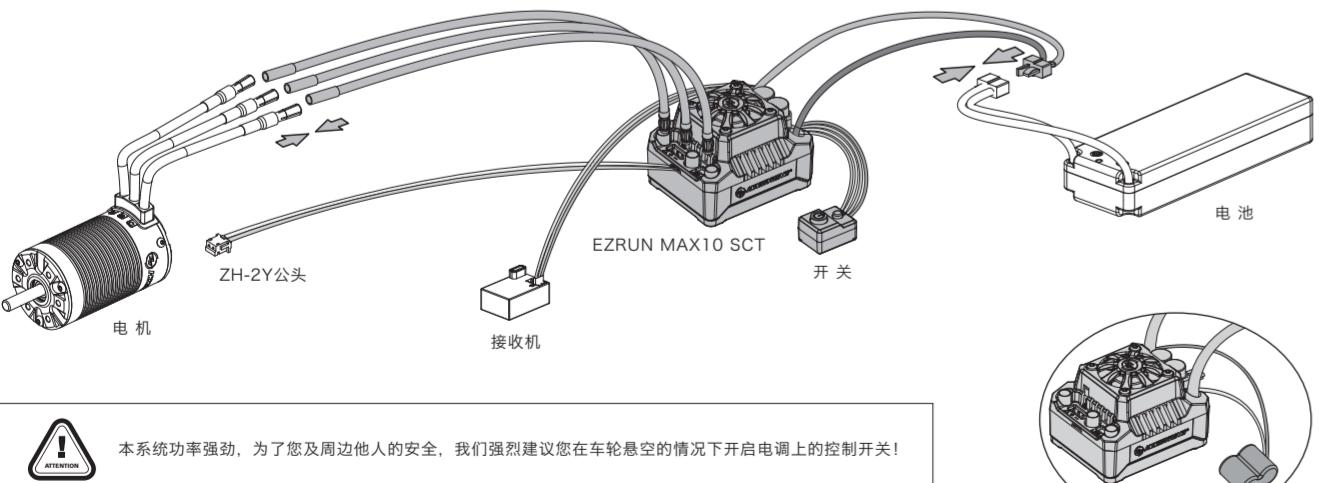
**1. 连接马达：**电调与马达相连无严格的线序要求，电调的#A/#B/#C可以与电机的三线随意对接，若出现转向相反，任意交换两条马达线即可。
