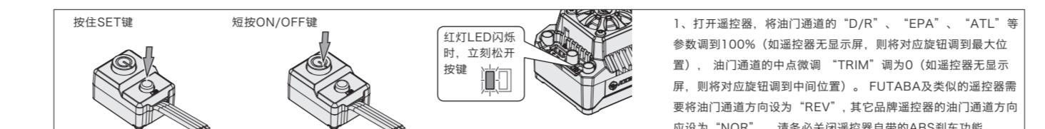
1、打开遥控器，将油门通道的“D/R”、“EPA”、“ATL”等参数调到100%（如遥控器无显示屏，则将对应旋钮调到最大位置）。油门通道的中点微调“TRIM”调为0（如遥控器无显示屏，则将对应旋钮调到中间位置）。FUTABA及类似的遥控器需要将油门通道方向设为“REV”，其它品牌遥控器的油门通道方向应设为“NOR”。请务必关闭遥控器自带的ABS刹车功能。
