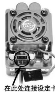
参数设定卡为车用电调的升级选配件, 体积小, 适合外场使用。其界面直观, 参数设定过程十分简单快捷。调整参数时, 使用标配的延长线, 将电调 AB 输出线之间的 3 针接口和设定卡上标注着 U+ 的插口相连 (请注意电调和设定卡上的信号针位、正极针位和负极针位要一一对应, 不可交叉连接), 然后给电调接上电源, 数秒后该电调的各项参数即可显示在设定卡上。利用设定卡上的“ITEM”和“VALUE”按键即可快速选择编程项目和参数值, 然后按“OK”键后, 新参数即可存入电调中。(详见设定卡说明书)
