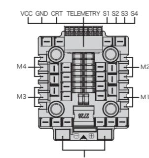
注意：需要对单个电调进行设定时，只连接对应电调的油门线与地线即可。
