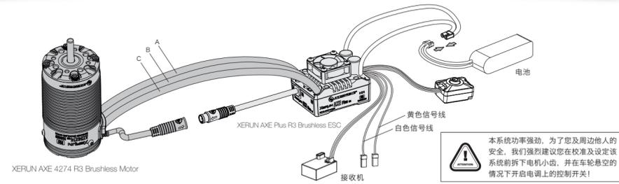
本系统功率强劲，为了您及周围他人的安全，我们强烈建议您在校准及设定该系统前拆下电机小齿，并在车轮悬空的情况下开启电调上的控制开关!
