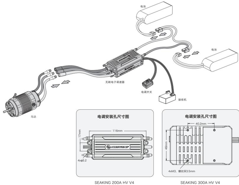
请参照接线说明及接线图正确接线：
